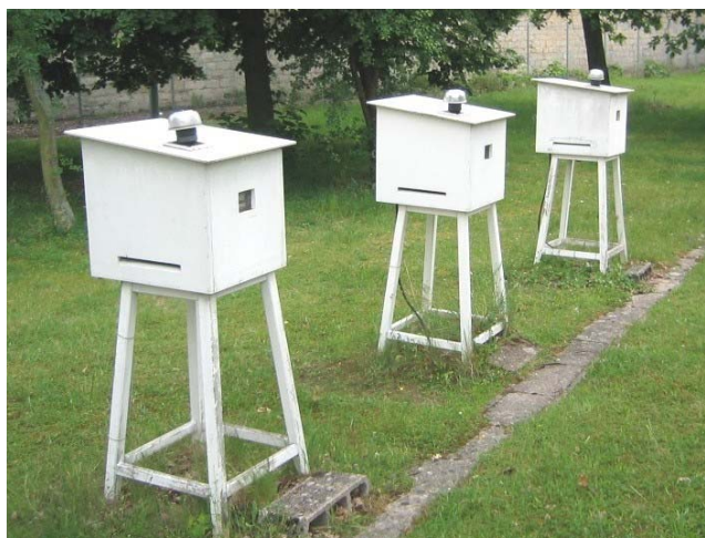
Réseau OPERA-Air de l'IRSN : stations de collecte d'aérosols (AS) faible débit pour la surveillance régulière de la radioactivité de l'air
